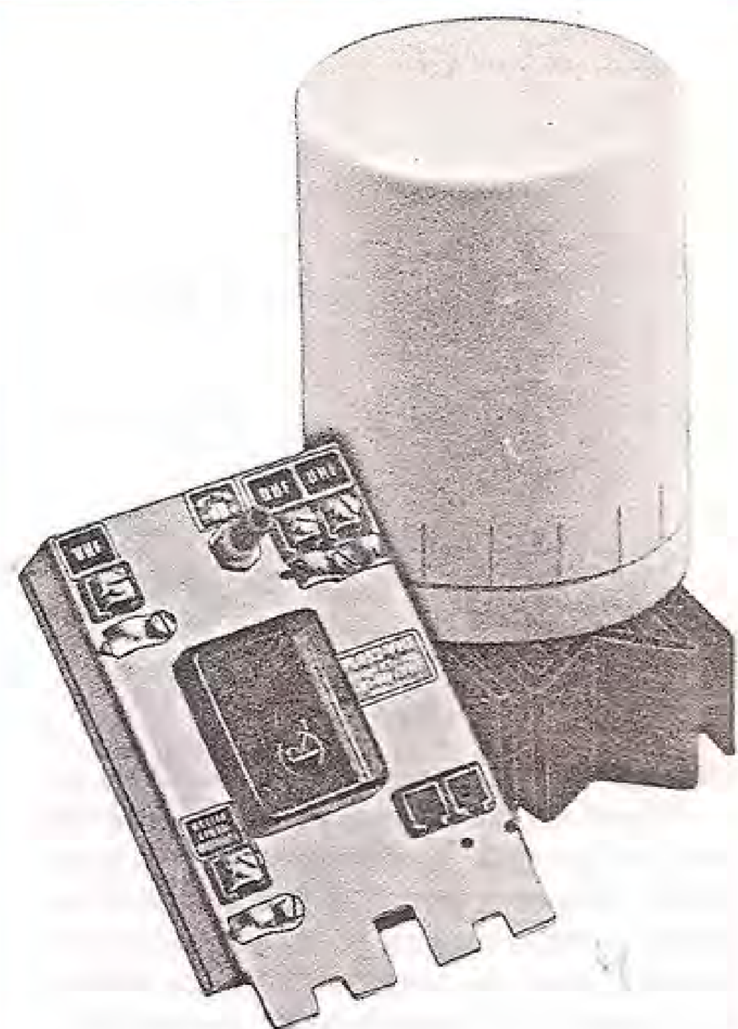
Fig.250 Foto di un amplificatore a larga banda con fissaggio su palo, completo di attenuatore.
