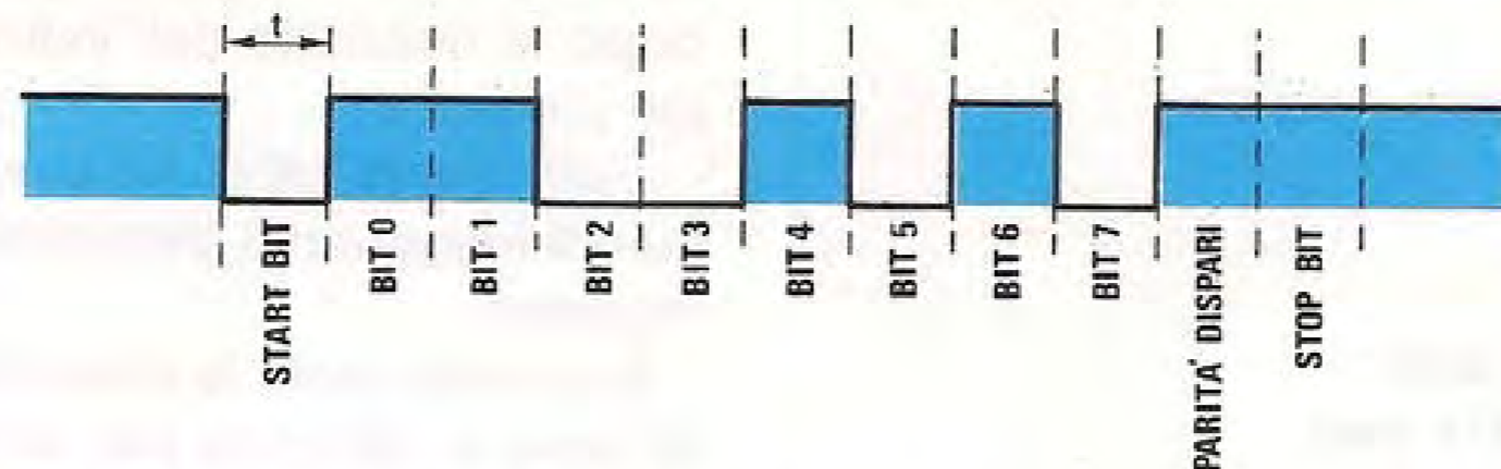
Fig.5 Il formato di ogni singola parola è rappresentato da un bit di Start (livello logico 0) seguito da 8 bit d'informazione (data), più uno di parità. Chiude la sequenza uno Stop (livello logico 1), che può durare da un 1 bit a 2 bit.
