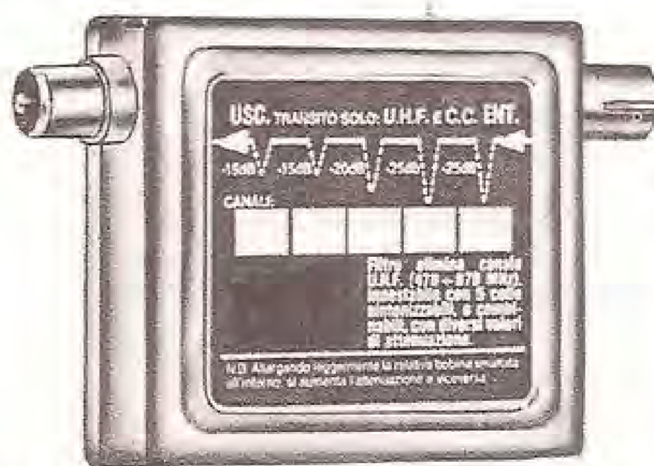
Fig. 266 Foto di un filtro "soppressore di canale". Le celle interne possono essere tarate per attenuare più canali oppure un solo canale.
