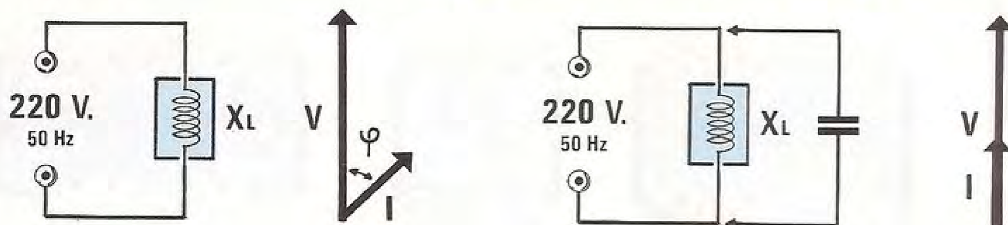
Fig.12 Se un carico "induttivo" applicato su una linea sfasa la corrente in "ritardo", per riportarla in fase sarà sufficiente applicare in parallelo un condensatore, la cui capacità sfasi in anticipo gli stessi gradi.
